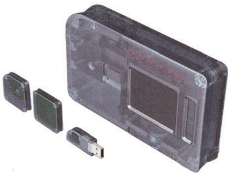
Bild 3: Aufbau des Schwingungs-Sensorpflasters
